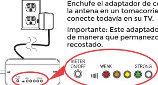
Enchufe el adaptador de corriente del amplificador de la antena en un tomacorriente estándar de CA. No lo conecte todavía en su TV.
